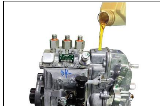
Fig. 268 - HET BIJVULLEN VAN DE VERSE SMEEROLIE
