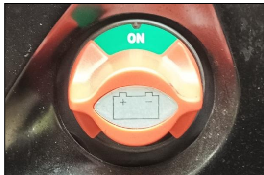
Fig. 320 - ACCU-ISOLATIESCHAKELAAR IN AAN-STAND
