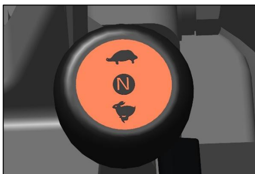
Fig. 156 - SCHILDPAD EN HAAS – HOOG/LAAG HENDEL
