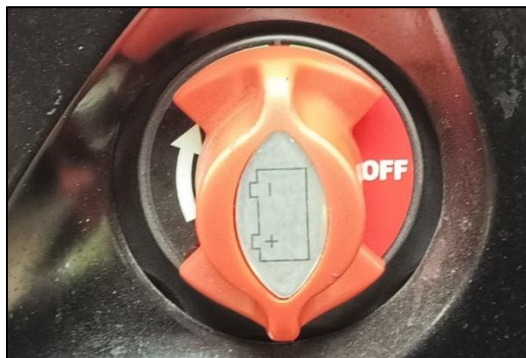
Fig. 321 - ACCU-ISOLATIESCHAKELAAR IN UIT- STAND
