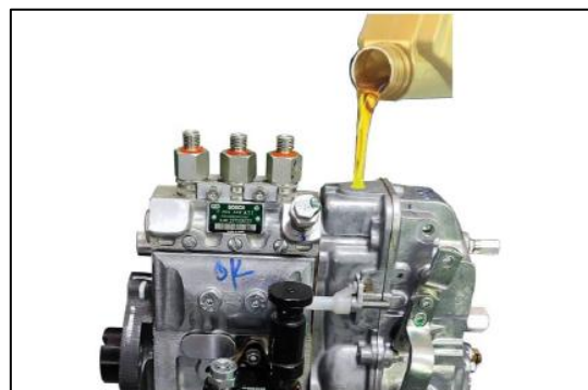
Fig. 264 – HET BIJVULLEN VAN DE VERSE SMEEROLIE
