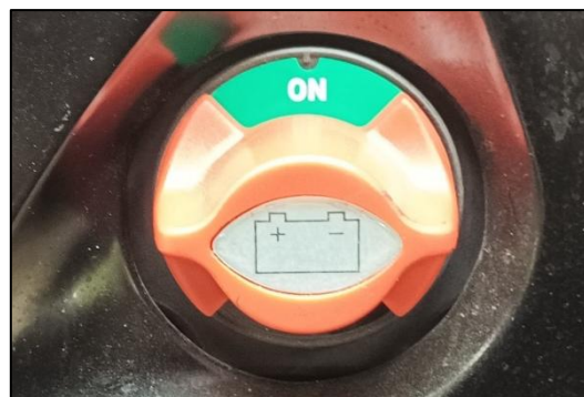
Fig. 320 : INTERRUPTEUR COUPE-BATTERIE EN POSITION ON
