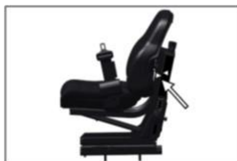
Fig. 141 : ALIGNEMENT DES FLÈCHES EN POSITION ASSISE
