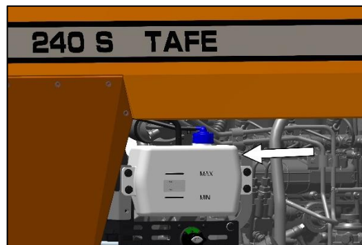
Fig. 275 : RÉSERVOIR DU LIQUIDE DE REFROIDISSEMENT
