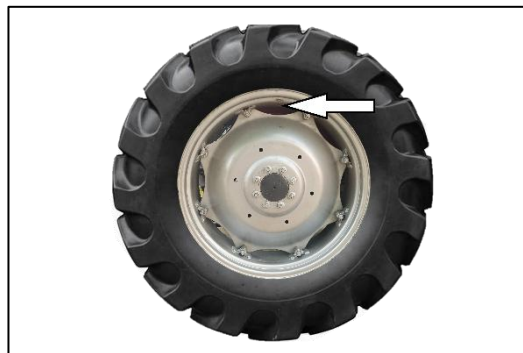
Fig. 233 : VALVE DU PNEU POSITIONNÉE AU POINT LE PLUS HAUT
