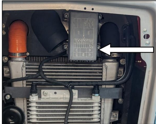
Fig. 343 : EMBLACEMENT DU BOÎTIER DE FUSIBLES
