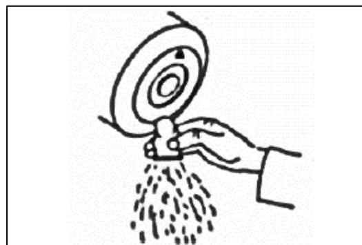
Fig. 249 : INDICATION DE LA FLÈCHE D'ENTRÉE
