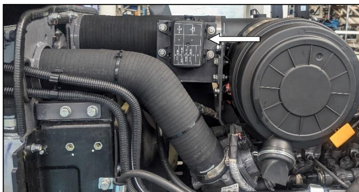
Fig. 345 : EMLACEMENT DU BOÎTIER DE FUSIBLES DE L'ECU MOTEUR
