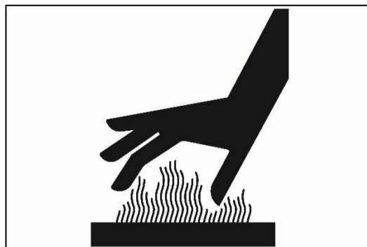
Afb. 50 – BRANDWONDEN AAN VINGERS OF HANDEN DOOR HETE OPPERVLAKKEN
