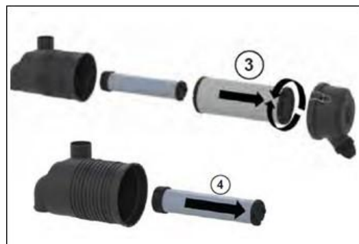
Abb. 164 – AUSBAU DES PRIMÄREN UND SEKUNDÄREN FILTERS
