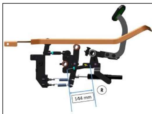
Fig. 176 - RÉGLAGE DE LA PÉDALE HST DE MARCHE ARRIÈRE
