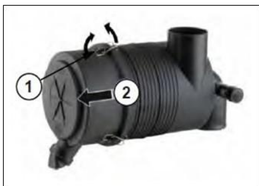
Fig. 163 - RETRAIT DE LA PARTIE INFÉRIEURE DU BOÎTIER
