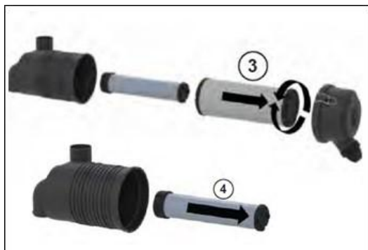
Fig. 164 - RETRAIT DES FILTRES PRINCIPAL ET SECONDAIRE
