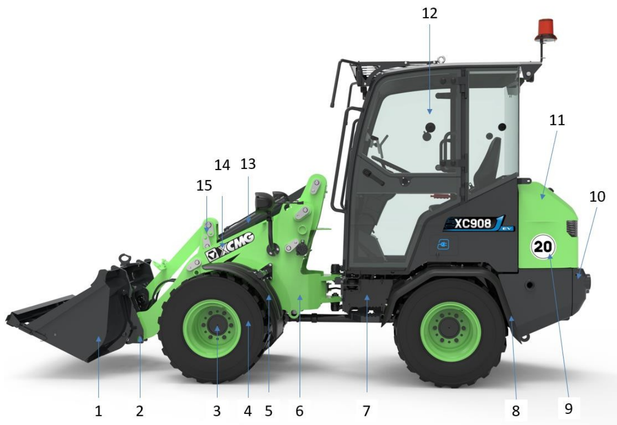
Afbeelding 5-1 Belangrijkste onderdelen van de machine
